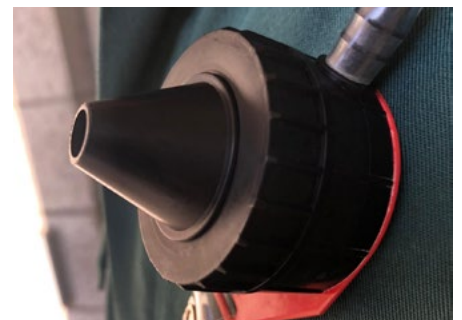
Foto 3 | Een foto van de monsternamekop waarmee lucht in de ademzone wordt aangezogen. Deze wordt bevestigd aan uw borstzak.
