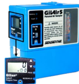
Foto 2 | Detailfoto van de luchtpomp die de voeding levert om lucht in de ademzone aan te zuigen. Deze wordt bevestigd aan uw riem.
