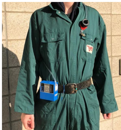
Foto 1 | Algemene impressie van de uitrusting die gedragen wordt tijdens de persoonlijke meting. U kunt de pomp en slang ook onder uw overall dragen.
